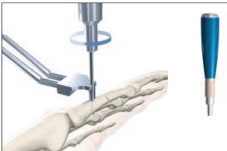
**Etape N° 2 :** Insérer manuellement la demi-fiche (à bout mousse ou auto-perforante/ auto-taraudeuse), à l'aide du guide-fiches 2 mm et du guide de perçage.
